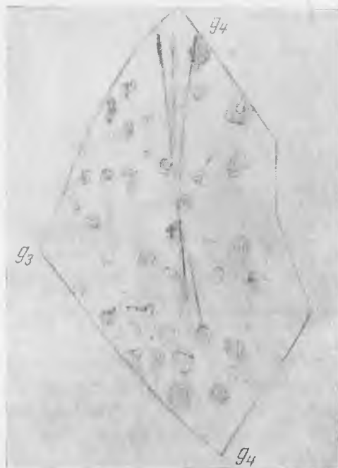
Рис. 16. Грань округлого кристалла алмаза с ямками травления. Дно ямок заштриховано
