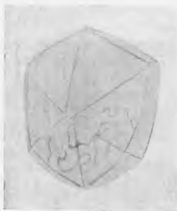
Рис. 15. Штриховка, аналогичная наблюдаемой на гранях кристалла алмаза, изображенного на рис. 14, развитая на протравленных участках граней
