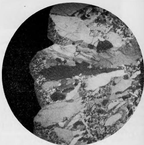
Рис. 4. Корочка друзового кварца с дюновидными образованиями.
