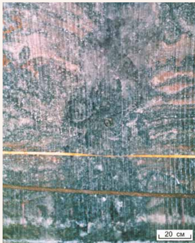
Рис. 2.29. Центральная часть одной из зон замещения типа «столб» пласт КрII, рудник СКРУ-2
