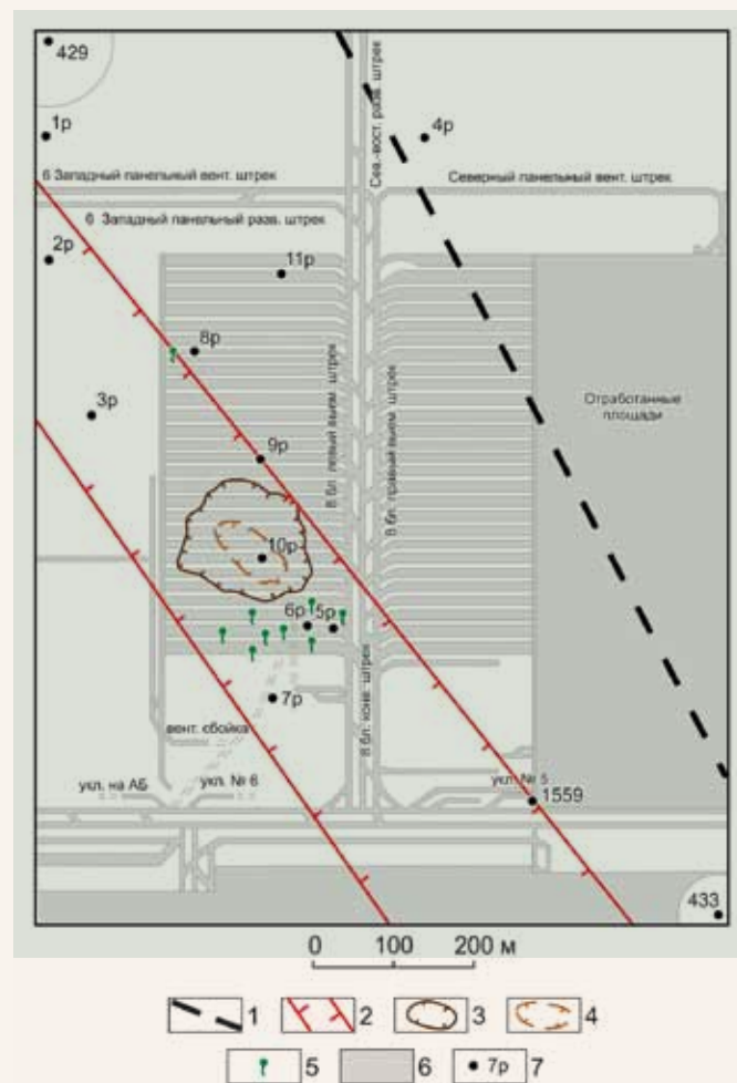
Рис. 1.58. Горно-геологическая ситуация района провала на БКПРУ-3: 1 – разлом № 88; 2 – линейная аномалия, отождествляемая с крутопадающими обводненными зонами повышенной трещиноватости пород надсолевой толщи (Беляев и др., 1989); 3 – контур провала земной поверхности по четвертичным отложениям (на 86.08.01.); 4 – контур провала земной поверхности по коренным отложениям (на 88.08.01); 5 – места поступления рассолов в горные выработки (на 86.01.15); 6 – отработанные площади; 7 – скважины
