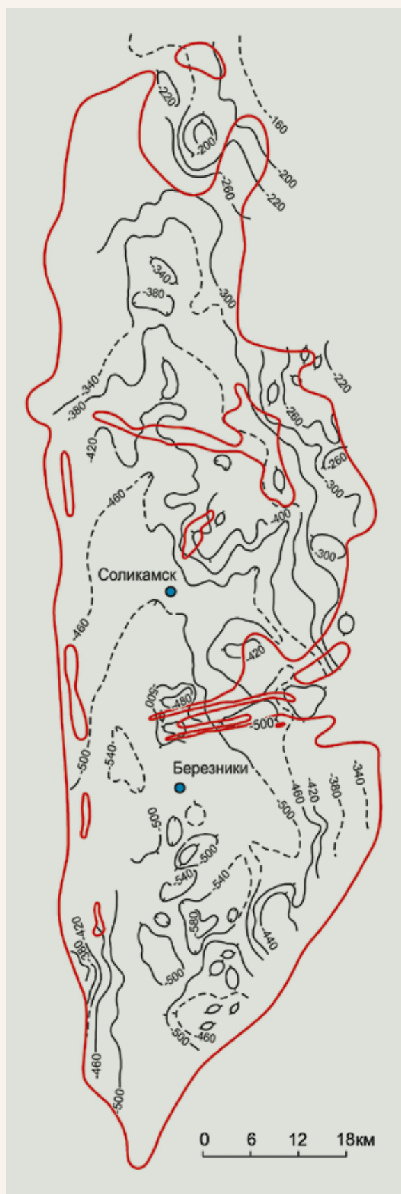
Рис. 1.29. Структурная карта по подошве соляной толщи в пределах калийной залежи ВКМС (по В.М. Голубеву, 1998 г.) Значение изолиний в метрах
