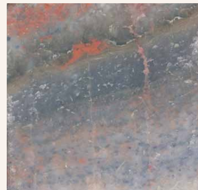
Рис. 2.73. Кливаж полосчатых сильвинитов пласта А (натуральная величина). Восточная стенка камеры 168, в 20 м от ее устья (фото Л.В. Андрейко)
