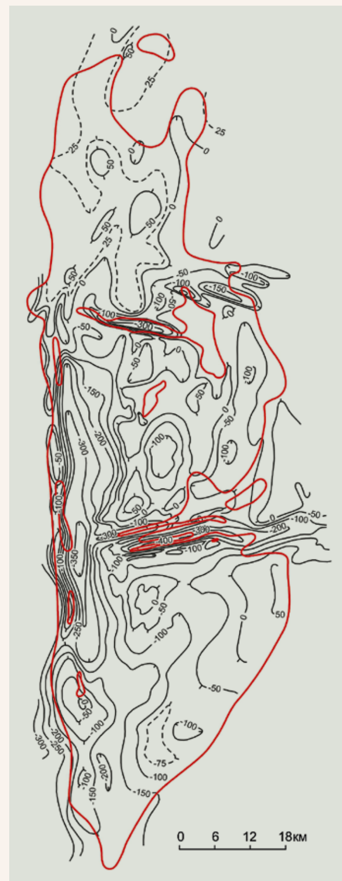
Рис. 1.30. Структурная карта по кровле ПКС в пределах калийной залежи ВКМС (по материалам Б.И. Сапегина и В.М. Голубева). Значение изолиний в метрах
