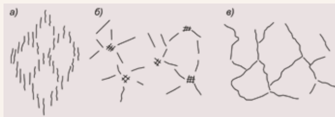
Рис. 2.75. Ячейчатая ромбовидная (а), неправильная прерывистая (б) и неправильная полигональная (в) сетки,
