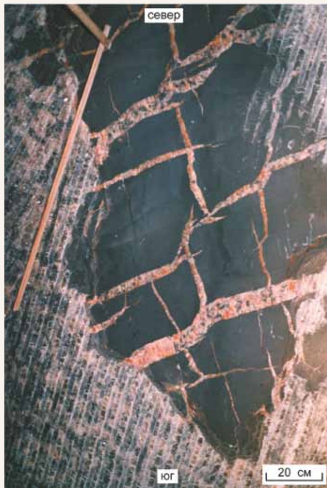
Рис. 2.77. Система соляных жил, секущих «книжечку» пласта КрI-КрII кровля камеры 8 блока 5 первой панели рудника СКРУ-3
