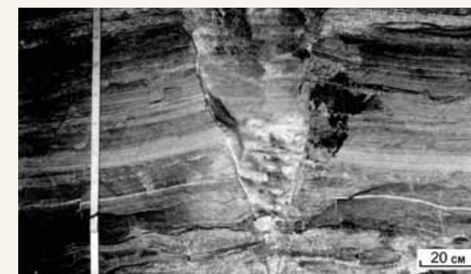
Рис. 2.84. Клиновидный раздвиг пласта МГ субширотного простирания (в районе ствола № 1 рудника СКРУ-3)
