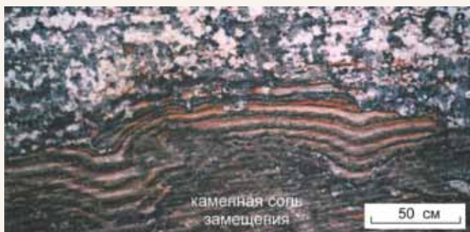
Рис. 3.35. Перекристаллизация полосчатого сильвинита пласта А с образованием пестрого сильвинита. Рудник БКПРУ-4
