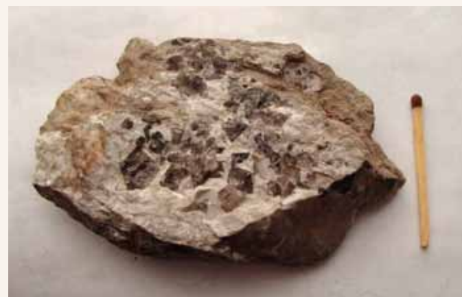
Рис. 2.101 Вкрапления железистого магнетита (брейнерита) (?) в карбонатно-сульфатной породе, вскрытой подземными горными выработками в районе скв. 484 (БКПРУ-4). Фото Ю.А. Плотникова
