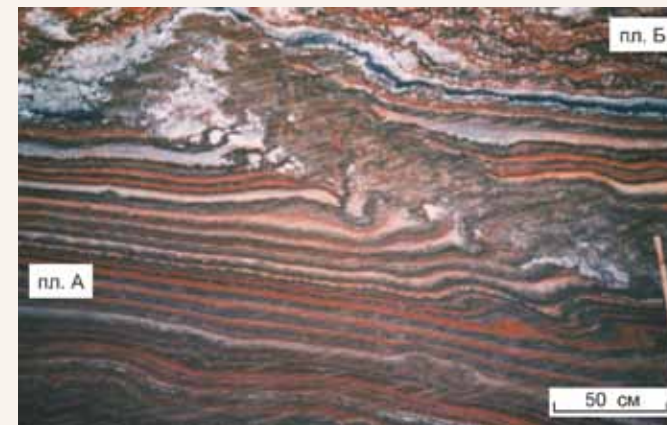
Рис. 2.26. Одноветвевая зона замещения (серое) типа «ушко» в полосчатом сильвините, пласт АБ, рудник СКРУ-3
