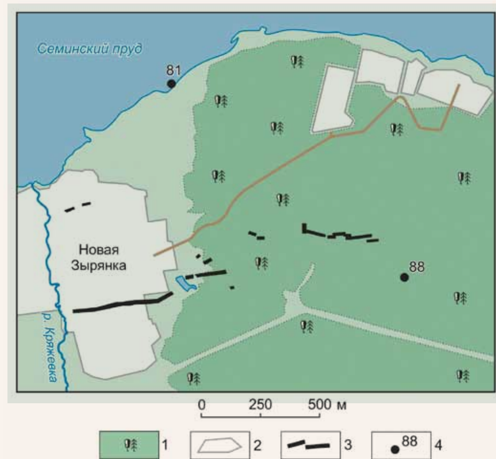
Рис. 1.64. Схема расположения провалов земной поверхности: 1 – лесной массив; 2 – жилые застройки; 3 – провальные образования; 4 – солеразведочные скважины и их номера
