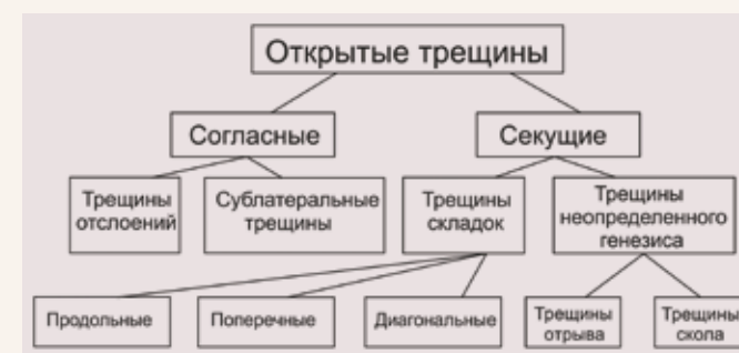
Рис. 2.58. Схема классификации открытых трещин: в соляной толще ВКМС
