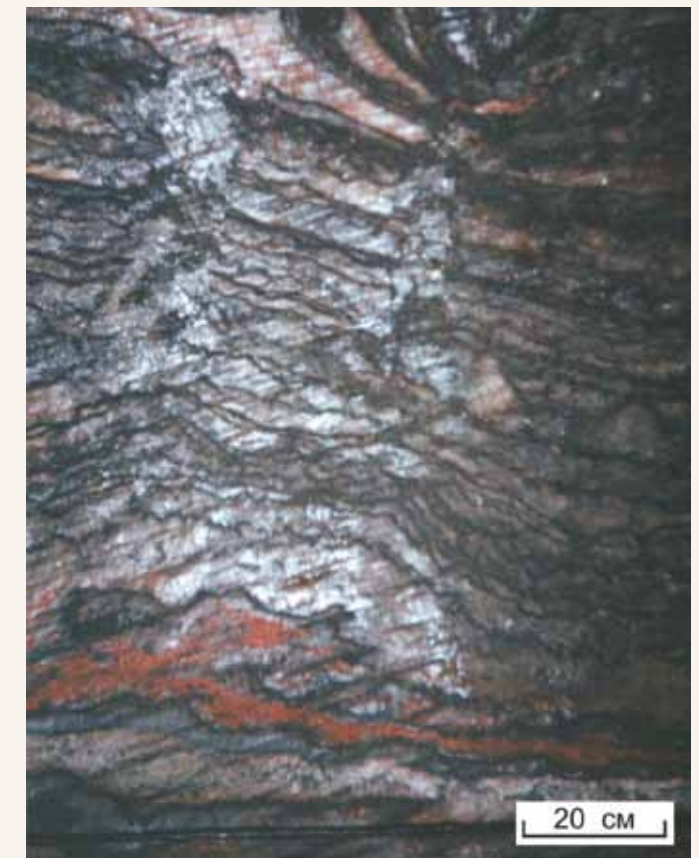
Рис. 3.27. Секущие слоистость полосы (светло-серое) перекристаллизации каменной соли одной из зон замещения красных сильвинитов пласта КрII. Рудник БКПРУ-4
