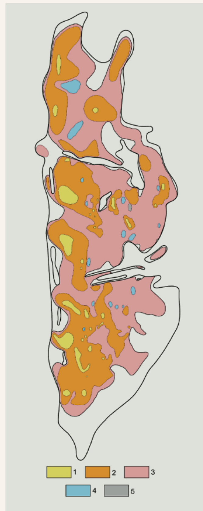
Рис. 1.18. Литологическая схема пласта Б: 1 – карналлитовые породы; 2 – смешанные соли; 3 – пестрые сильвиниты; 4 – каменная соль; 5 – гипсово-глинистые шляпы. Остальные условные обозначения см. на рис. 1.16
