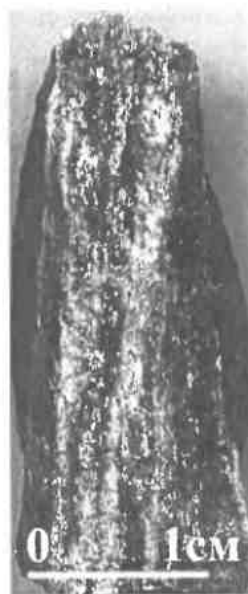
Рис. 3. Сколок керна полосчатой кварц-альбит-амфибол-карбонат-хлоритовой породы. Видны тонкие карбонатные зоны (белое). Интервал 26,0-27,0 м.
