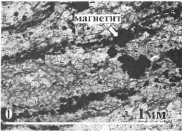
Рис. 6. Полосчатые выделения кристаллов магнетита. Глубина 45,0 м.
