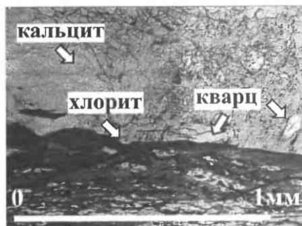
Рис. 4. Снимок шлифа карбонатной зоны на границе с хлоритовой зоной. Внутри карбонатной зоны присутствуют кварц и хлорит. Карбонат представлен кальцитом.
