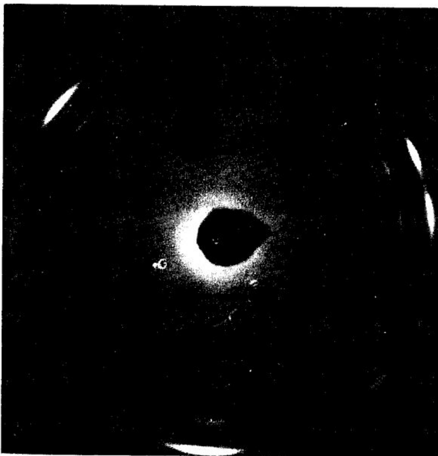
Рис. 5.10. Лауэграммы импактных алмазов, содержащих лонсдейлит (шесть сигналов от \{111\} указывают на двойниковый характер его сложения):
