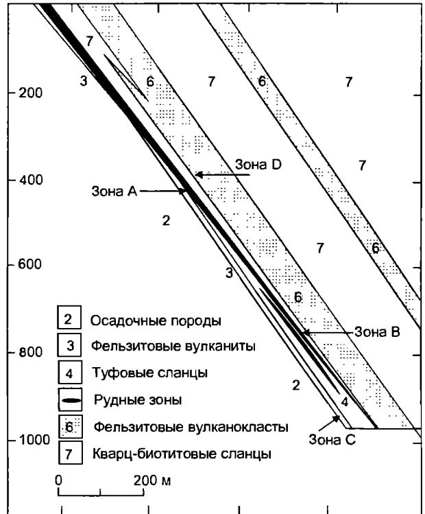
Рис. 96. Схематический разрез через месторождение Хемло, показывающий положение основных рудных залежей в разрезе [Valliant, 1985]
