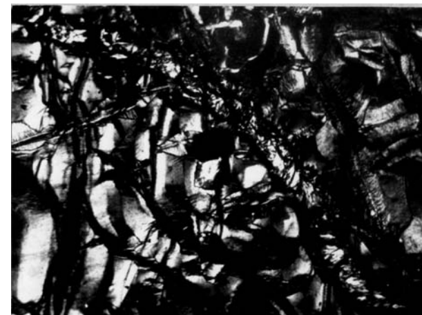
Рис. 4. Замещение ленточно-пластинчатого \beta -лизардита микро- и листовато-пластинчатым антигоритом в лизардитовом серпентините. Южный участок, Третья зона разломов, скв. 3415, гл. 216 м, увел. 80, с анализатором.
