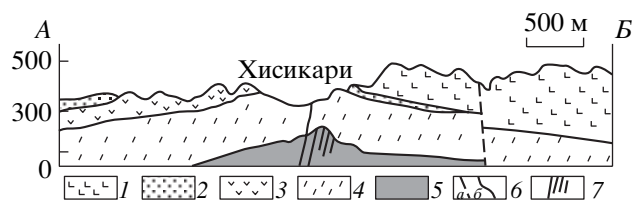
Рис. 1. Геологический разрез вкосте простираения эпитермальных жил месторождения Хисикари, Япония (по [11]). 1–4 – плейстоценовые вулканические породы: 1 – биотит-горнблендитовые дациты, 2 – дацитовые пирокласты, 3 – гиперстен-авгитовые андезиты, 4 – андезитовые пирокласты; 5 – переслаивание меловых песчаников и алевролитов; 6 – разломы (а), геологические границы (б); 7 – эпитермальные жилы месторождения Хисикари.
