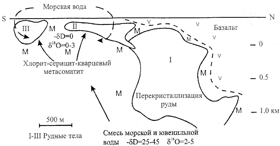
Рис. 5. Схема эволюции изотопного состава водного флюида на совмещенной продольной вертикальной проекции рудных зон и рудных тел Гайского месторождения.
