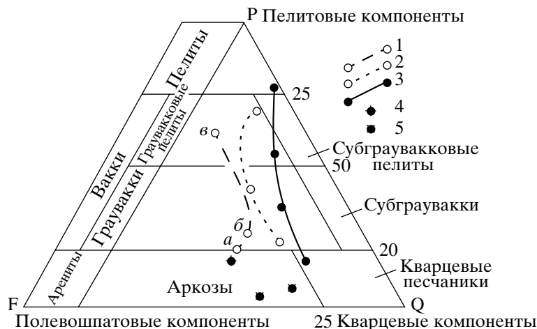
Рис. 4. Тренды осадочно-метаморфических пород Гранулитового пояса Балтийского щита, гранатовых гранулитов Анабарского щита и граувакк генотипической местности на модифицированной диаграмме Ф. Петтиджона [Розен, 1993].
