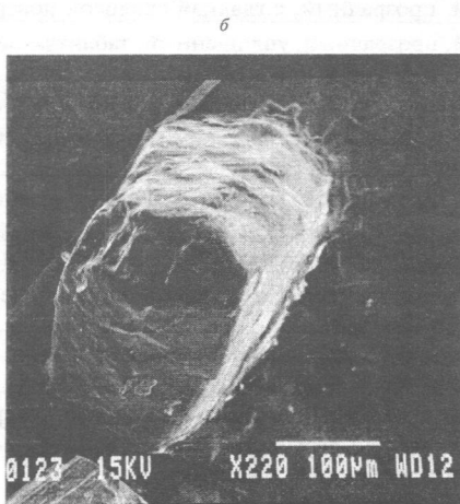
Рис. 4. Шпинелевые двойники октаэдрических микрокристаллов алмаза: а — гладкогранный; б — с корродированной поверхностью
