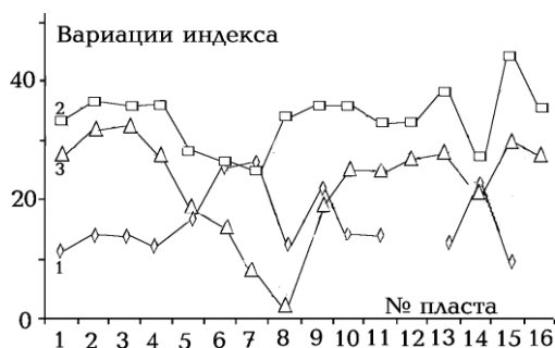
Рис. 6.6. График зависимости содержания железа от индекса сероцветности в железистых пластах Кременчугского района (третий ярус) по [11]. Среднее содержание железа в пласте (%) 1 - средний индекс сероцветности, 2 - общее содержание железа, 3 - магнетитовое железо.
