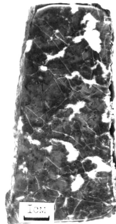
Рис. 4. Иловатый микрозернистый известняк узорчатой текстуры с неправильными гнездами вторичного кальцита. Полировка. Западный склон Среднего Урала, р.Уфа. Средний девон, эйфельский ярус.
