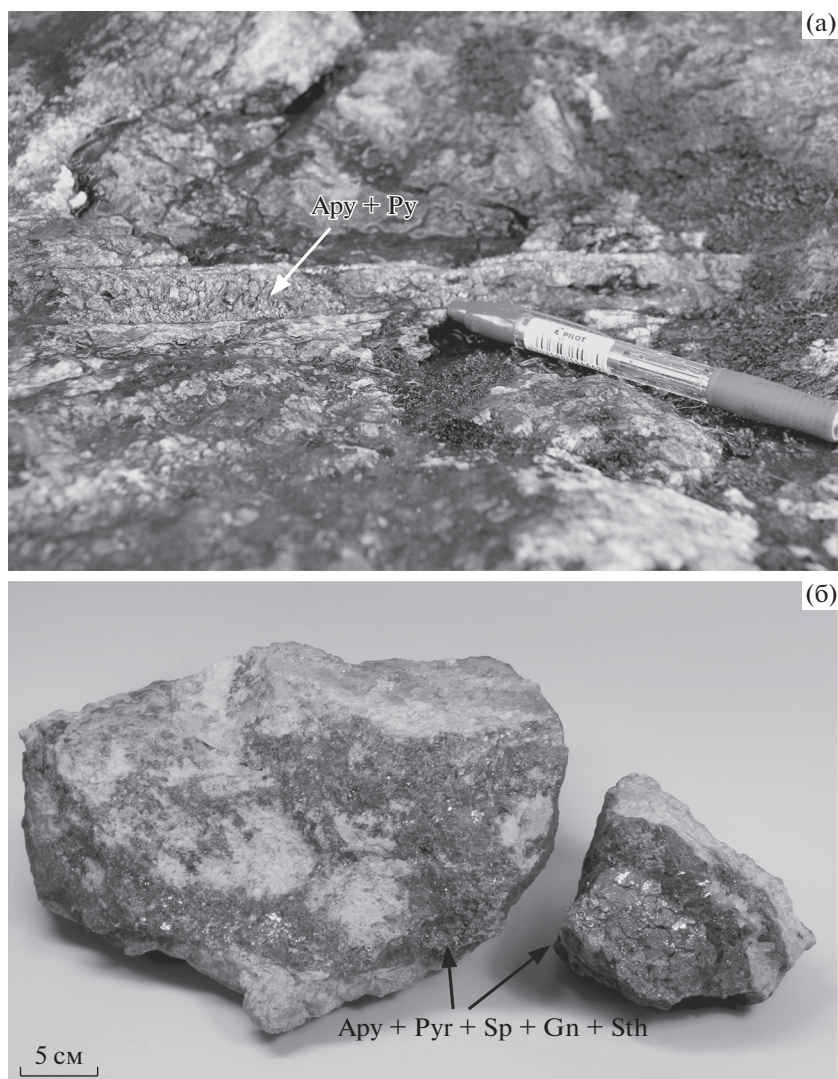
Фиг. 5. а – выходы рудной пирит-арсенопирит-кварцевой жилы Колта в современном эрозионном срезе, б – образцы руд с арсенопирит-полиметаллической минерализацией жилы Кубус.
