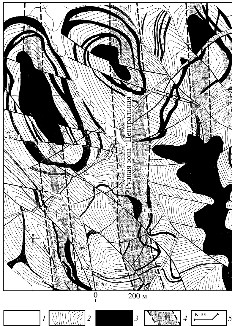
Рис. 2. Схематический геологический план Центральной части месторождения Тэутэджак. 1 – четвертичные отложения; 2 – терригенные породы верхоянского комплекса; 3 – позднеюрские штоки, силы и дайки диоритов и диоритовых порфиритов; 4 – рудные зоны; 5 – разведочные канавы.
