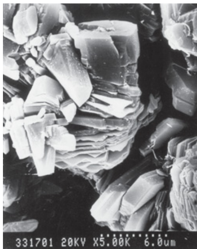
Рис. 2. Локализация пакетов каолинита в межпоровом канале. Ромашкинское месторождение, горизонт D_1 , скв. 20694, инт.1796 – 1803 м. Ув. 1500х.
