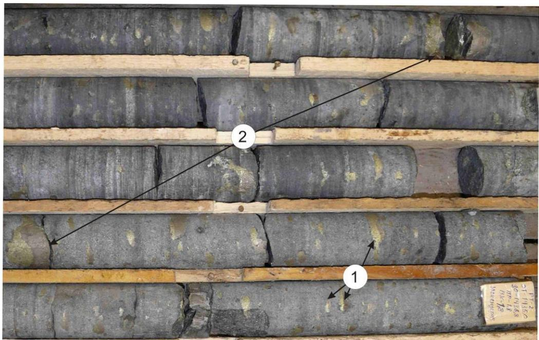
Рис. 2.3. Пикритовый габбродолерит, отчетливо видна типичная для норильских рудоносных интрузий уплощенная, каплевидная, расслоенная вкрапленность халькопирит-пирротинового состава (1) и два шлира (2) размером более 5 см. Хараелахский интрузив скв. ПТ-2.
