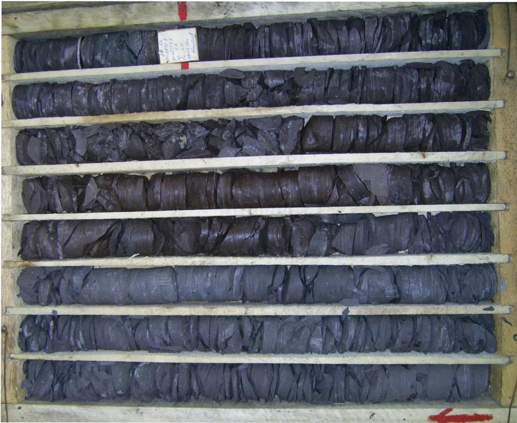
**Рис. 6.2.** Тонкоплитчатая отдельность в аргиллитах разведочной свиты по скв. 3Ф-54. Северный фланг Хараелахского интрузива.
