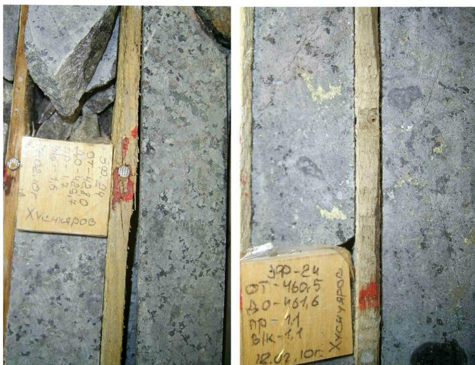
Рис. 2.5. Лейкогаббро (слева) и такситовидный габбродолерит с вкрапленностью халькопирит-пирротинового состава (справа) в апофизе Хараелахского интрузива, отнесенного к круглогорскому типу в скв. 3Ф-24.
