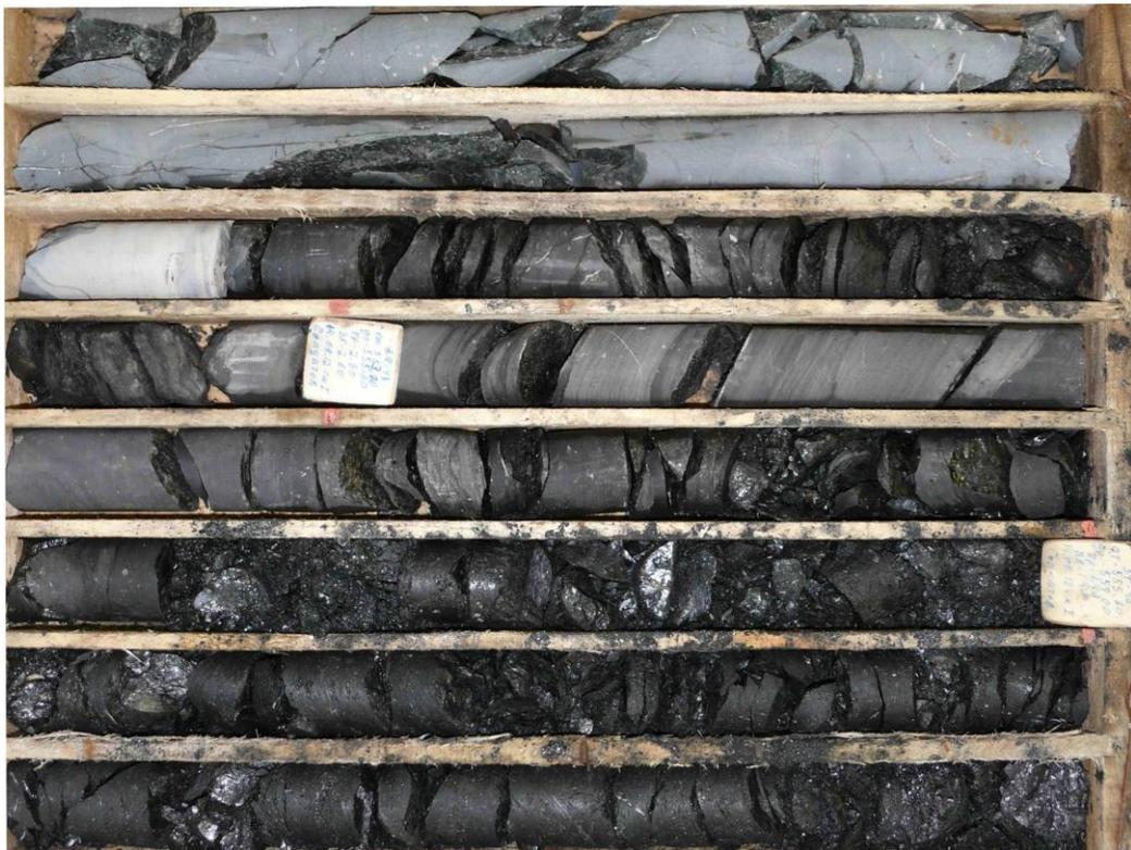
**Рис. 6.3.** Контакт долерита (вверху) с углистым аргиллитом, имеющим тонкоплитчатую отдельность, и пластом угля (внизу) в кайерканской свите по скв. 3Ф-48. Северный фланг Хараелахского интрузива.
