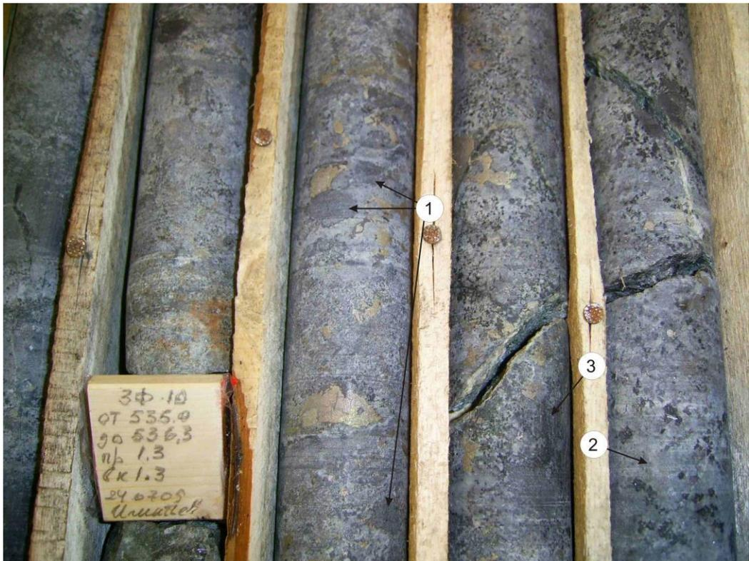
Рис. 2.2. Такситовый габбродолерит, отчетливо видны обломки с острыми углами (1), лейкократовые (2) и меланократовые (3) участки с различной степенью раскristаллизации и типичная для такситов ксеноморфная расслоенная вкрапленность халькопирит-пирротинового состава. Хараелахский интрузив скв. 3Ф-10.
