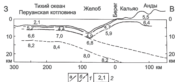
Рис. 7. Поперечный геолого-геофизический разрез через ОДС Перу—Чили (Fisher, Raitt, 1962):
