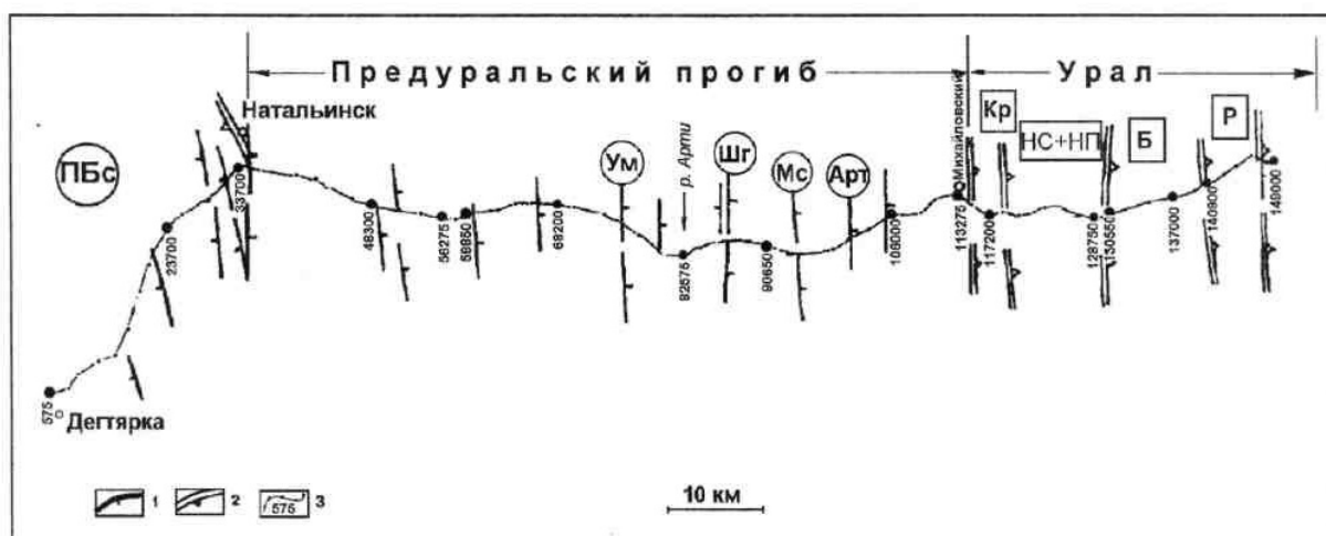
Рис. 1. Схема расположения на местности Михайловского сейсмопрофиля: 1 — надвиги; 2 — фронтальная зона шарьяжа; 3 — пикеты сейсмопрофиля (м)
