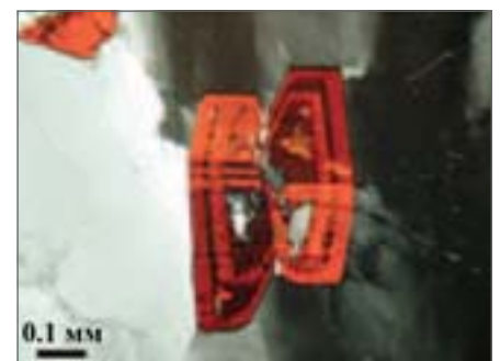
Рис. 3. Зональные кристаллы пьомонита. Петрографический шлиф, николи Ч. Приведено по [14]
