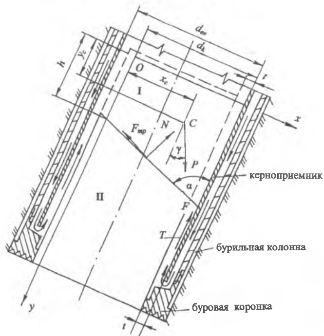
Рис. 1. Силы, действующие на керн в наклонной скважине, при обратном потоке раствора
