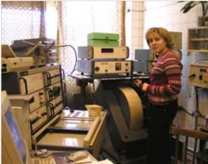
Радиоспектрометр SE/X-2547 (Radiopan, Poland). Оператор Е. Котова
