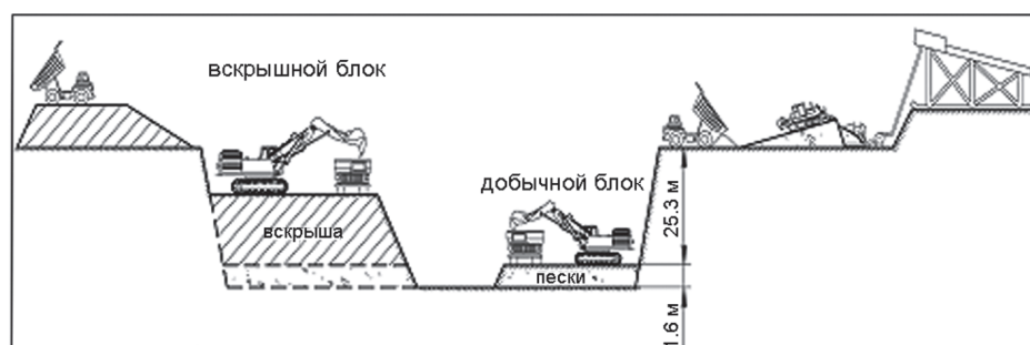
Рис. 1. Схема экскаваторно-транспортной технологии разработки россыпи руч. Ольгин с промывкой песков на ПГШ-II-50.
