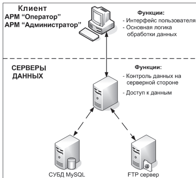
Рис. 4. Использование двухуровневой архитектуры “клиент-сервер” в системе.
