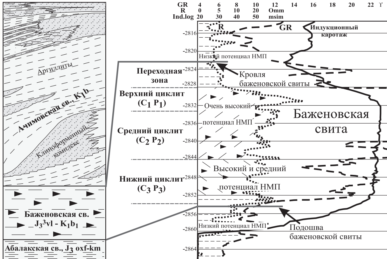
Рис. 3. Генерализованный разрез баженовской свиты в скв. № 16 Маслиховской площади
