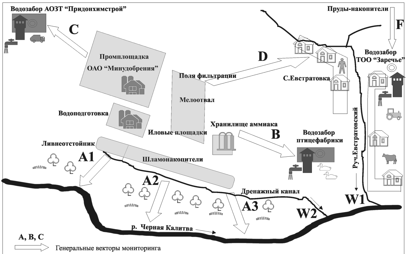
Рис. 2. Модель ПТЭС «ОАО» Минудобрения — геологическая среда в граничных объектах и генеральные вектора мониторинга
