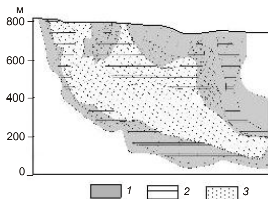
Рис. 5. Схема метасоматической зональности рудной залежи в разрезе по линии +50, по С.Ф.Стружкову, М.В.Наталенко:
