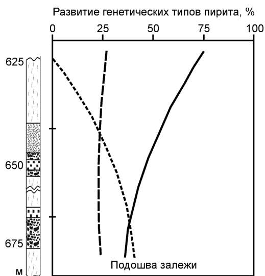
Рис. 5. Обратная минералофизическая зональность Орского месторождения, Южный Урал
