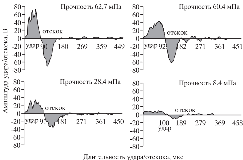
Рис. 4. Спектральные характеристики “удар–отскок” единичных тестов прочности поверхностей ледниковых валунов склерометром “Оникс 2.6.2” (Мандычанский плейстоцен–голоценовый ледниковый комплекс, хр. Черского)
