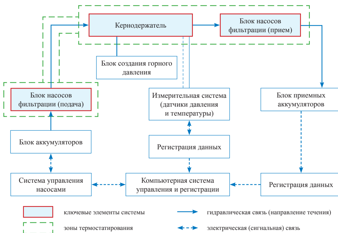
Рис. 1. Функциональная блок-схема экспериментальной установки для исследования поведения гидратов метана в пористой среде
