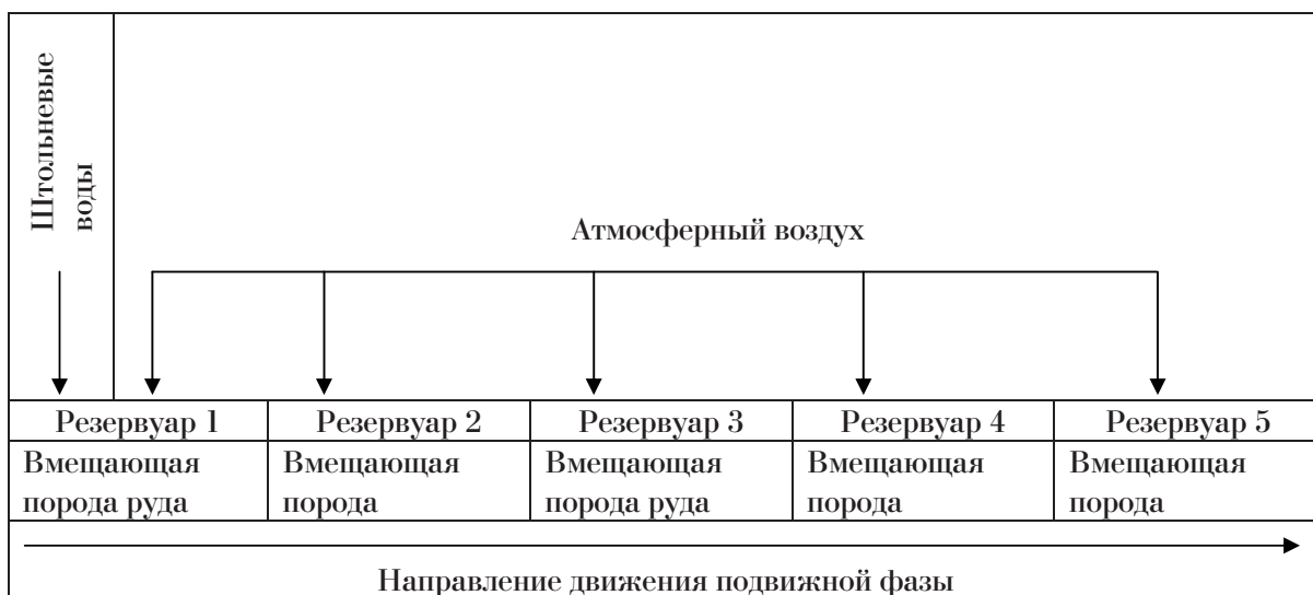
Рис. 1. Схема термодинамической модели миграции и минерагеза меди
