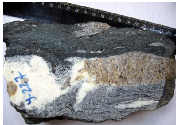
Рис. 6. Кварцевый прожилок, представленный дымчатым крупнозернистым кварцем слюдяногорского типа с наложенной альбититовой минерализацией. Вмещающие породы и тонкий кварцевый прожилок метаморфической дифференциации рассланцованы и смяты в мелкие складки. Карьер по отработке жилы 170, Кыштымское месторождение кварца. Натуральная величина
