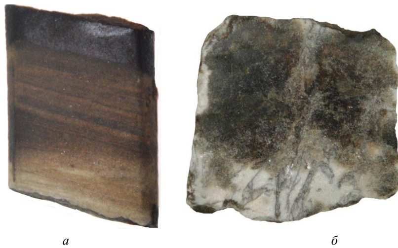
Рис. 5. Фото поверхности спила керн из зоны ВНК эрозионного вреза: a – начальная стадия формирования без существенной карбонатной цементации; б – конечная стадия формирования с интенсивной кальцитовой цементацией
