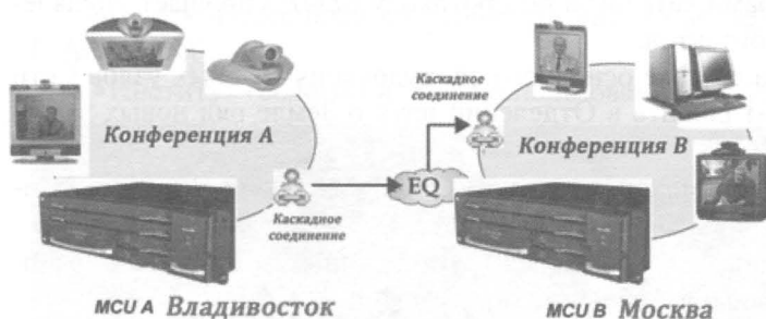
Рис. 4. Общая схема Системы видеоконференцсвязи ОНЗ РАН после выполнения работ первого этапа
