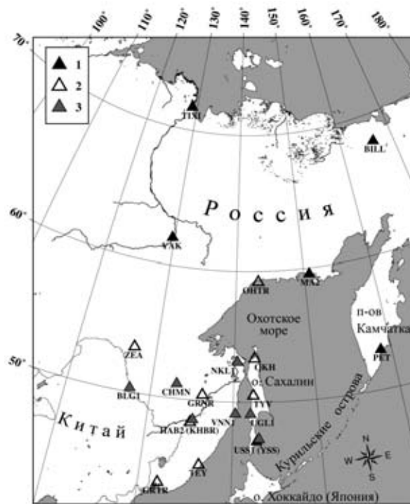
Рис. 1. Сеть цифровой регистрирующей аппаратуры с широкополосными сейсмометрами STS-1 (1), STS-2 (2) и RefTek 151-120 (3) на юге Дальнего Востока России на начало 2011 г. Карта построена в программе GMT [9]
