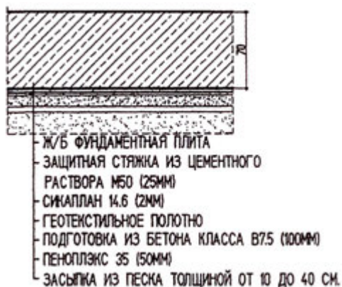
Рис. 13. Поперечный разрез плиты и подстилающих материалов
