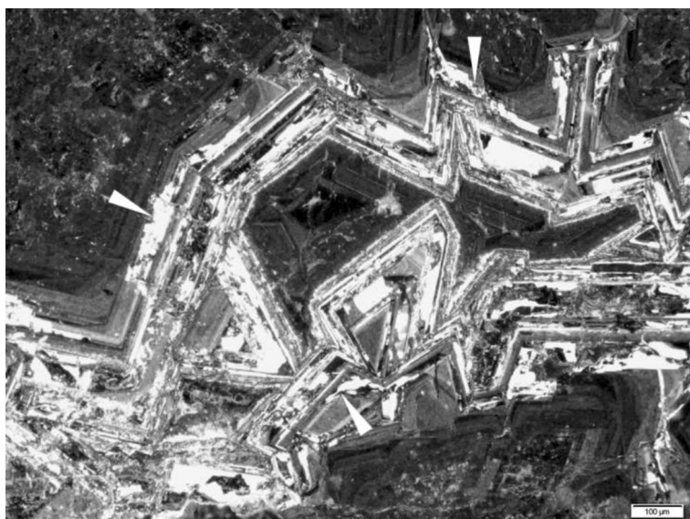
Рис. 3. Фотография трещинного доломита (вингольдинская свита) при катодолюминесцентном свечении. Белые стрелки указывают на участки растворения отдельных зон в кристаллах доломита
