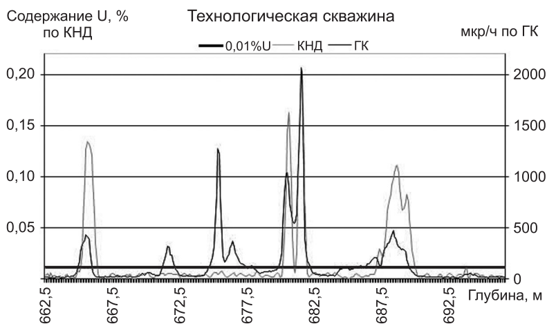
Рис. 1. Результаты сопоставления данных ГК и КНД-м в технологической скважине месторождения Буденновское
