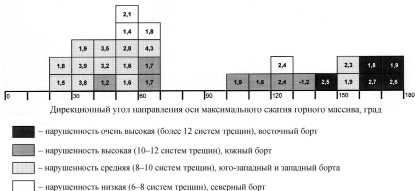
Рис. 4. Диаграмма с результатами расчетов соотношения и ориентировки главных осей тензора первоначальных напряжений горного массива в окрестностях карьера «Удачный» для каждого из 29 реперов при \sigma_1 = -1 МПа и модуле упругости массива E = 1700 МПа (столбцы 6 и 7 табл. 1). На горизонтальной оси в азимутальном интервале 0–180° с шагом 10° отложены дирекционные углы направления оси \sigma_2 , а по вертикали – частотность выявления соответствующего направления с расчетными значениями \sigma_2/\sigma_1 и степенью нарушения массива в районе установки того или иного репера
