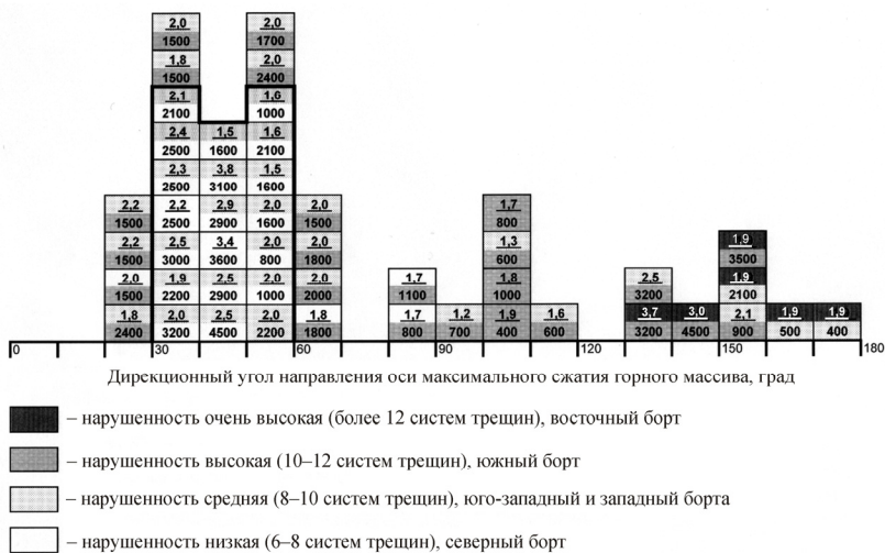
Рис. 5. Диаграмма с результатами расчетов соотношения \sigma_2/\sigma_1 , модуля упругости E и ориентировки главных осей тензора первоначальных напряжений горного массива в окрестностях карьера «Удачный» для каждой из 48 парных комбинаций реперов (столбцы 3–5 табл. 2). На горизонтальной оси в азимутальном интервале 0–180° с шагом 10° отложены дирекционные углы направления оси \sigma_2 , а по вертикали – частотность выявления соответствующего направления с расчетными значениями \sigma_2/\sigma_1 (представлено в числителе), модулем упругости E (представлено в знаменателе в долях \sigma_1 ) и степенью нарушения массива (представлено заливкой) в районе установки репера
