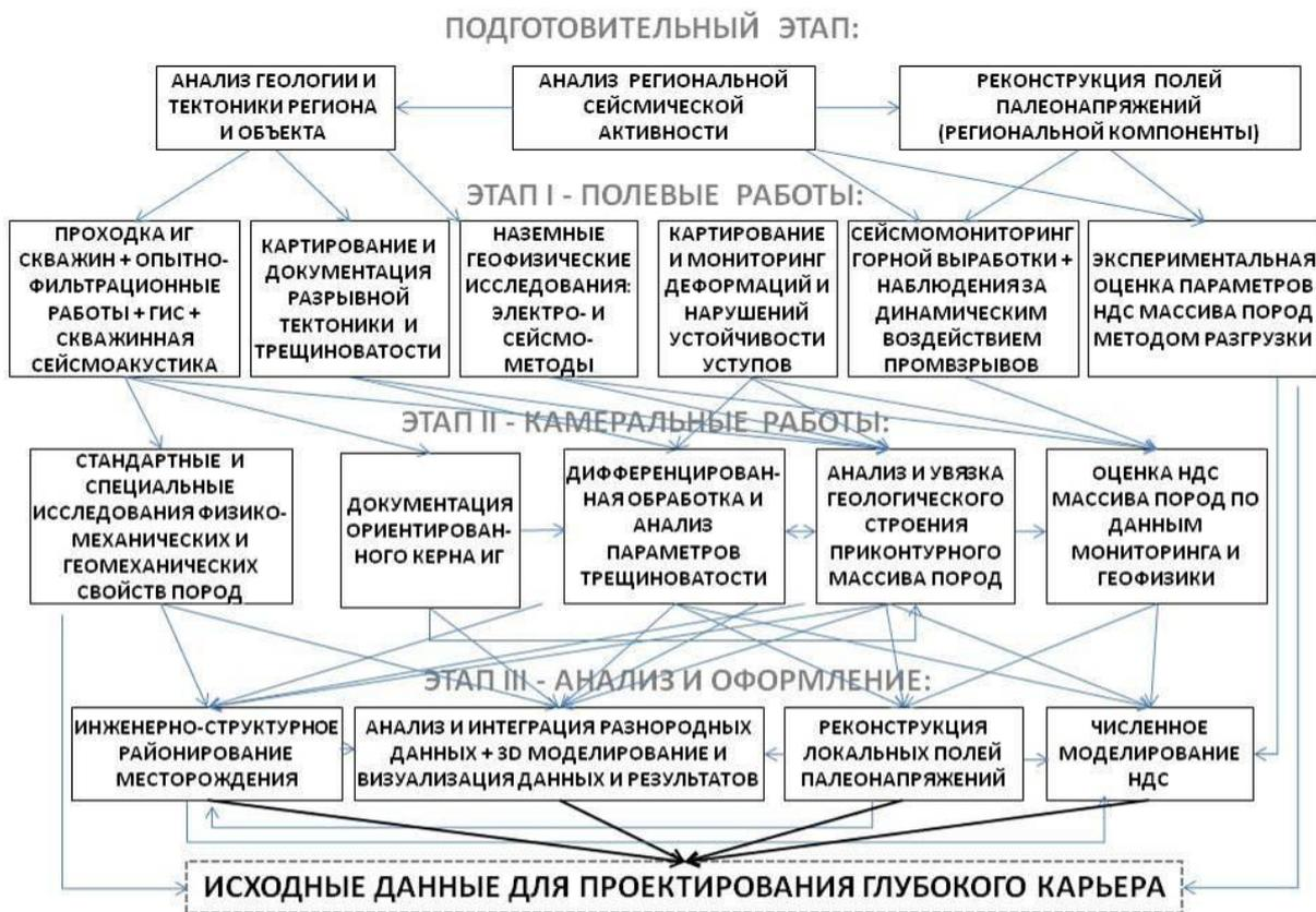
Рис. 3. Компонентно-организационная диаграмма комплекса инженерно-геологических и геомеханических исследований и наблюдений для обоснования проектирования глубокого карьера
