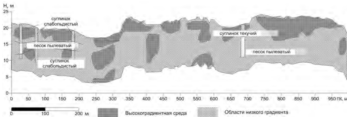
Рис.3. Разрез градиента УЭС
