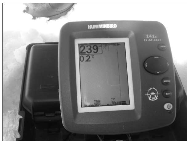
Рис. 4. Эта модель эхолота может измерять глубину до 240 м
