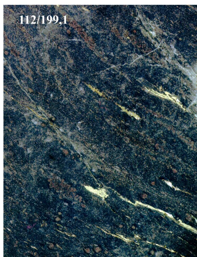
Рисунок 3.3 – Пришлифовки керн. Ув. 1,5^{\times} . Сетчатые нитевидные прожилки кварц-карбонатного, карбонатного состава в сланцах рудоносной минерализованной зоны. В сланце и прожилках развита пиритовая, пирит-пирротиновая и арсенопиритовая минерализация
