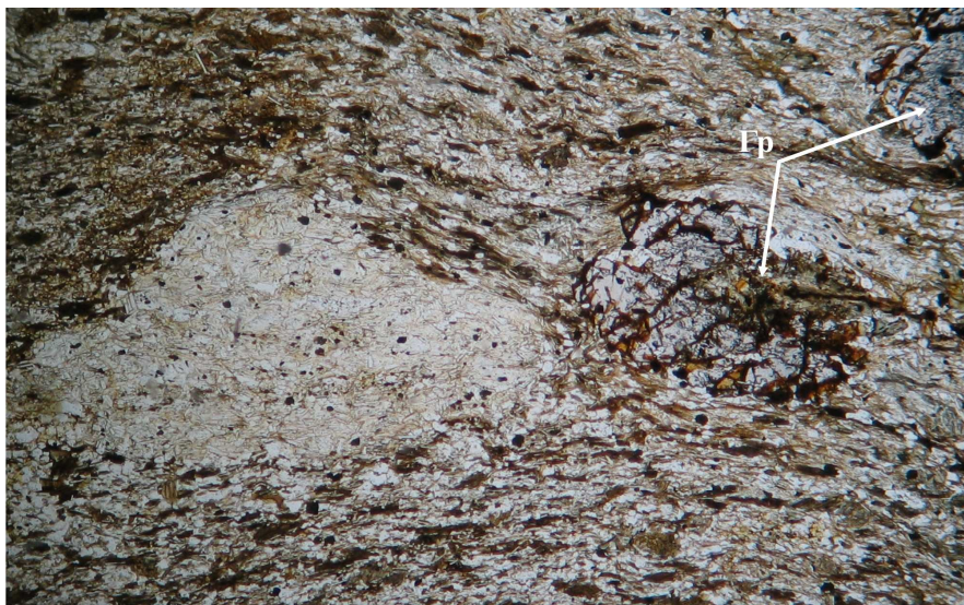
Рисунок 2.11 – Прозрачный шлиф ПР I-50. Николи “-”. Ув. (15) х . Пятнистый ставролитовый сланец (RF kd 1 ). Уплощенные линзовидные светлые обособления спутанно-лепидобластического агрегата мусковита и порфирировые выделения граната (Гр), обтекаемые плагиоклаз-слюдисто-кварцевой тканью
