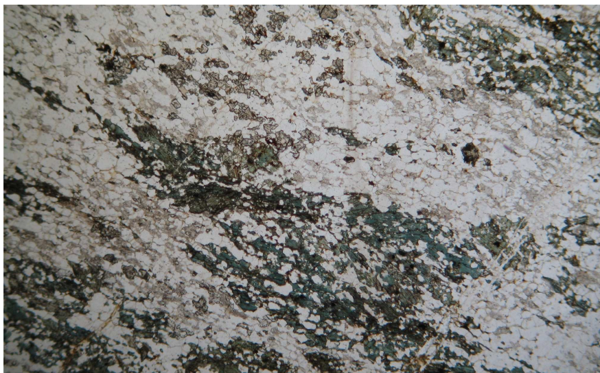
Рисунок 2.10 – Прозрачный шлиф ПР VI-10. Николи “-”. Ув. (50)^{\times} . Кварцевая разновидность кварцитовидного лейкократового сланца (RF, kd_2^2 ). Ситовидные пойкилобласты граната и актинолита в существенно кварцевой основной ткани
