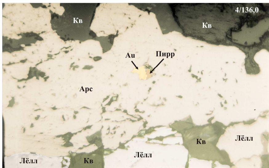
Рисунок 3.9 – Аншлиф 4/136,0. Ув. 120 х . Николи “-”. Прожилковая текстура. Пирит-пирротин-арсенопиритовая ассоциация. В центральной части арсенопиритового агрегата сросток пирротина и золота. Внизу леллингит
