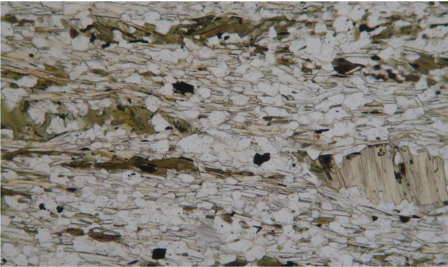
Рисунок 2.7 – Прозрачный шлиф ПР V-20. Николи “-”. Ув. (50) x . Кварцитовидный мезократовый сланец (RF 1 kd 2 2 ). Порфиробластический биотит ориентирован под углом к сланцеватости. Мелкие чешуйки хлоритизированного биотита образуют сростки и гнезда из нескольких индивидов
