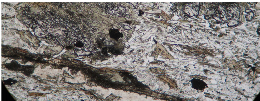
Рисунок 2.34 – Прозрачный шлиф 86/226,1. Николи “-”. Ув. (50) x . Мусковит-кварцевый сланец (RF, kd, '). Зона Б-0. Прожилки гидротермально-метасоматического полевого шпата и прожилки железистого (?) карбоната и хлорита. Значительный катаклиз порфириобластов граната, трещины заполнены хлоритом
