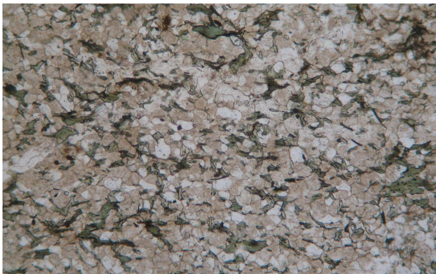
Рисунок 2.9 – Прозрачный шлиф ПР V-30. Николи “-”. Ув. (50)^{\times} . Кварцитовидный лейкократовый аркозовый сланец (RF, kd_2^2 ). Беспорядочно ориентированные чешуйки хлоритизированного биотита в бластоалевритовой кварцево-полевошпатовой ткани
