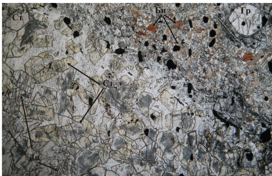
Рисунок 2.27 – Прозрачный шлиф 111/62,0. Николи “-”. Ув. (15)^x . Дистен-силлиманит-ставролитовый сланец ( RF, kd_1^1 ). Псевдоморфное замещение ставролитом (Ст), дистеном (Ди), мусковитом андалузита среди мелкозернистой основной ткани
