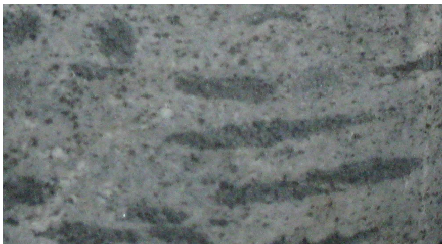
Рисунок 2.24 – Образец 100/156,4. Масштаб 3:1. Пятнистый ставролитовый сланец с темным метаобломочным материалом ( RF_1kd_3^1 ). Темные линзовидные и полигональные гранат-ставролит-слюдисто-кварцевые обломки на фоне светло-серого мусковит-кварцевого агрегата
