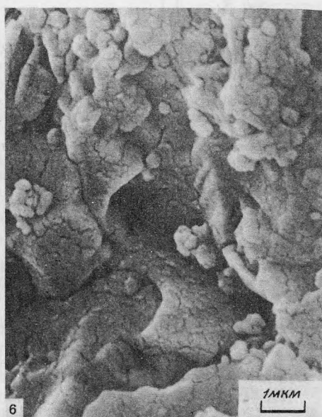
Рис. 5. Глобулярная структура хризопраза в сканирующем электронном микроскопе, Шкляри, ПНР (обр. 74805); травление HF, напыление углем и серебром
