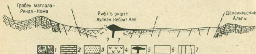
Рис. 20. Схематический разрез Данакильского рифта. По Д. Баннеру и др. 1 — фундамент; 2 — мезозой; 3 — верхнетретичные отложения; 4 — соленосная серия; 5 — четвертичные вулканы; 6 — четвертичные породы; 7 — разломы
