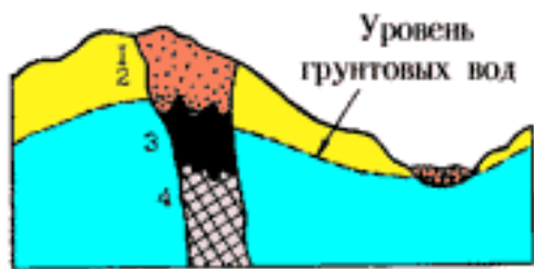
Рис. 76. Схема зоны окисления рудных месторождений.
