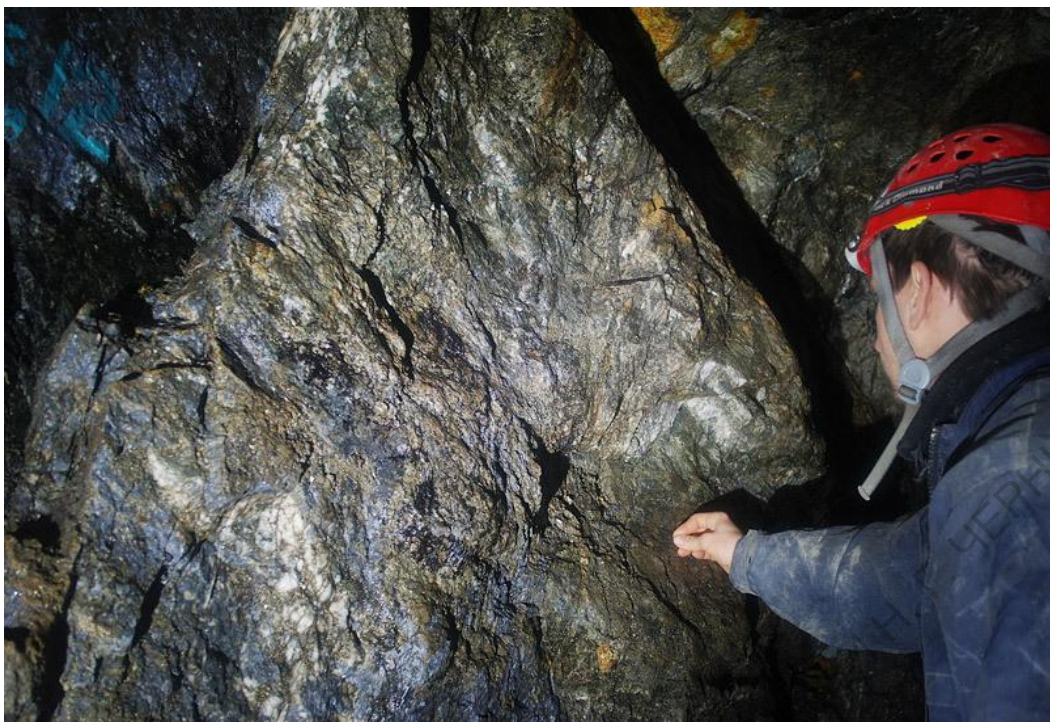
Рис. 70. Сфалерит-галенитовая руда в подземном забое рудника Згид, Сев. Кавказ.
