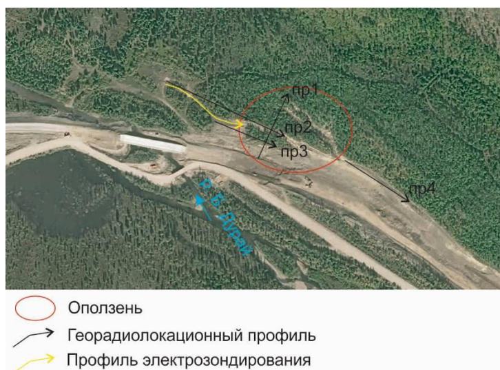
Рис. 1. Расположение геофизических профилей на оползневом участке 450 км федеральной автотрассы «Лена»
