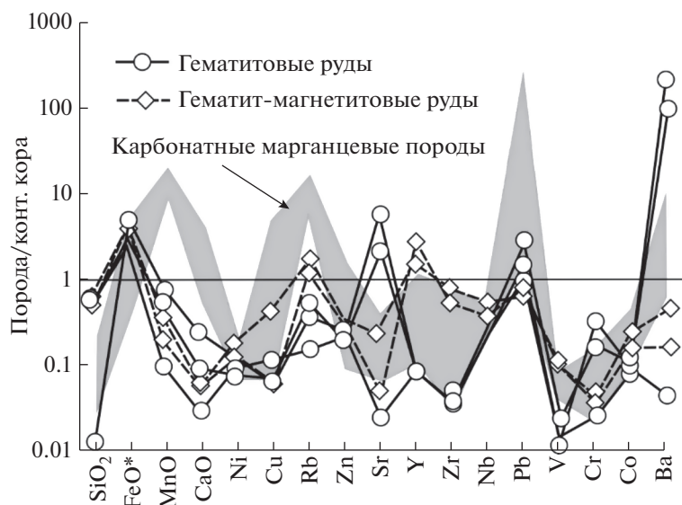
Рис. 3 Спектры распределения редких элементов, нормализованные к составу континентальной коры (Тейлор, Мак-Леннан, 1988) для рудоносных пород якинской (тилимской) свиты.
