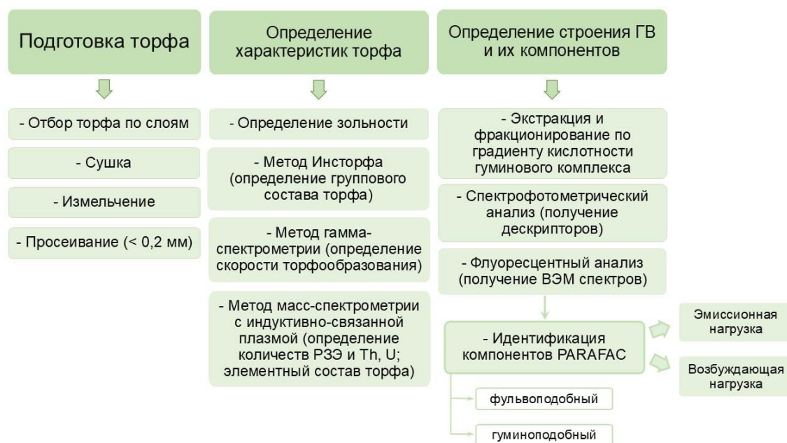
Рис. 2. Блок-схема аналитического рабочего процесса Fig. 2. Analytical workflow block diagram
