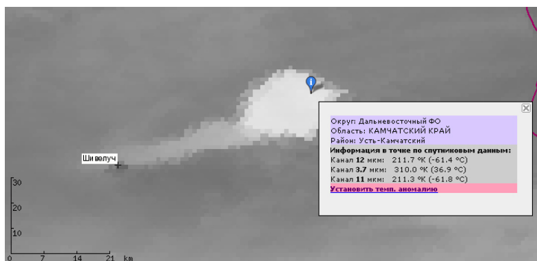
Рис. 7.3. Температура пеплового шлейфа вулкана Шивелуч на спутниковом снимке TERRA MODIS от 01:17 UTC 28 февраля 2015 г., по данным ИС VolSatView
